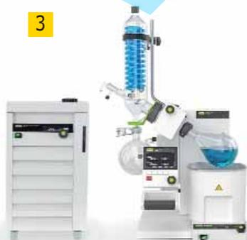
3 Rotavapor® P-300 система с интерфейсом I-300 с рециркуляционным охладителем F-305
